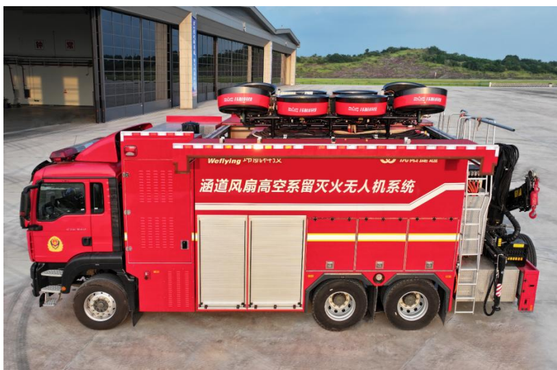
图 11 玮航科技“敖钦”涵道风扇高空系留灭火无人机系统
